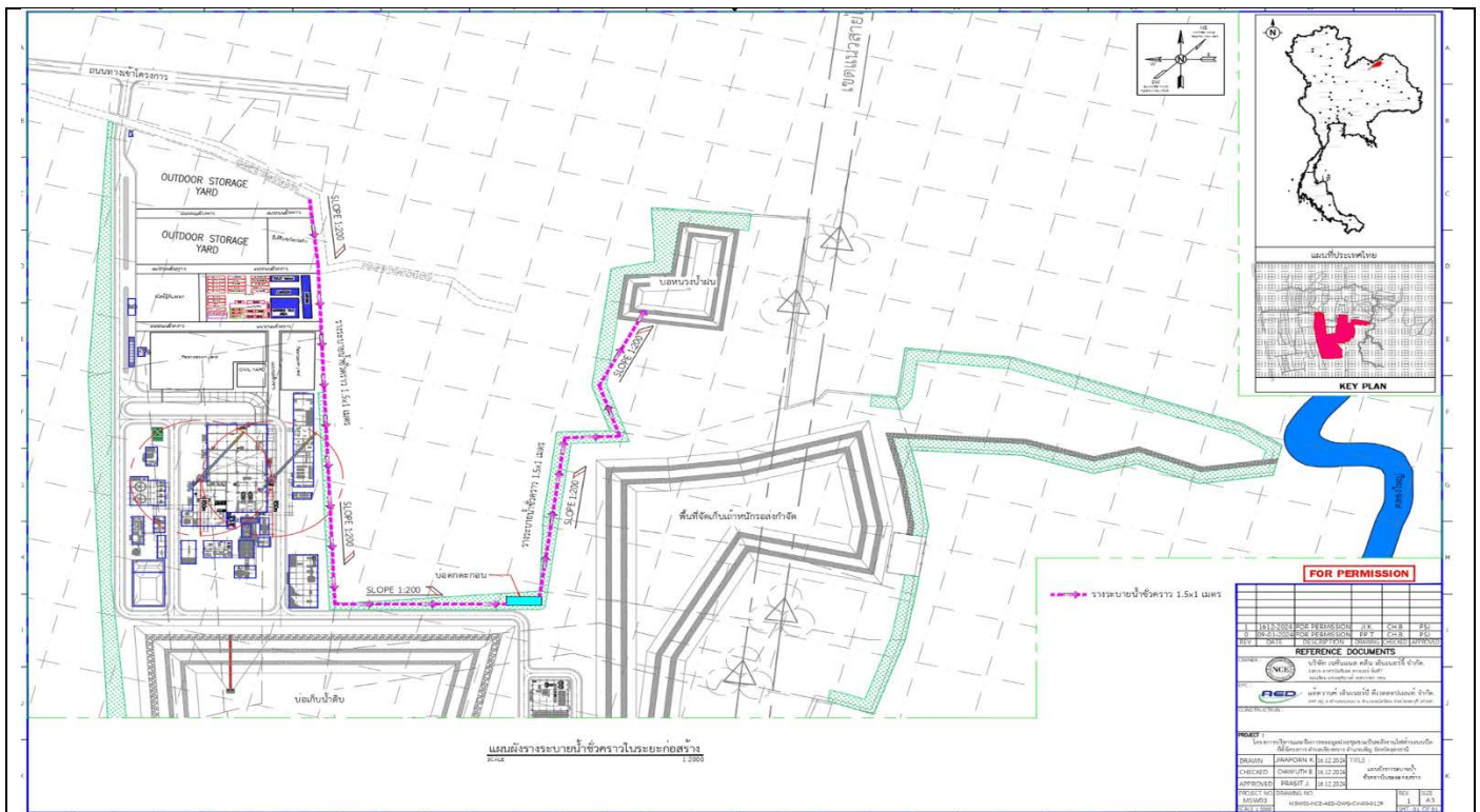
ผังระบบระบายน้ำชั่วคราวในระยะก่อสร้าง เดิม รายละเอียดในเอกสารเผยแพร่ขั้นตอนการจัดรับฟังความคิดเห็นฯ
