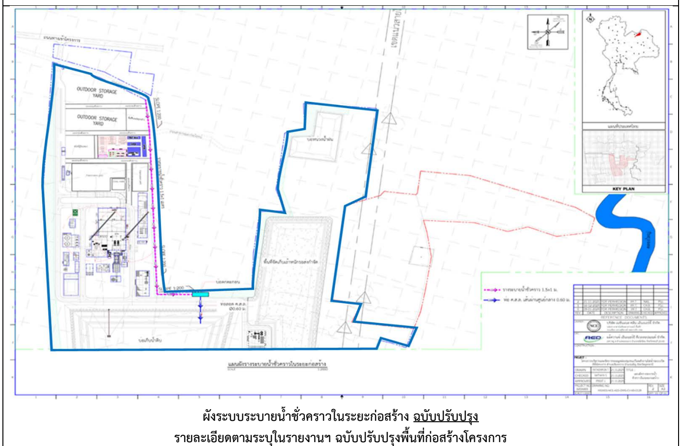
ผังระบบระบายน้ำชั่วคราวในระยะก่อสร้าง เดิม รายละเอียดในเอกสารเผยแพร่ขั้นตอนการจัดรับฟังความคิดเห็นฯ
